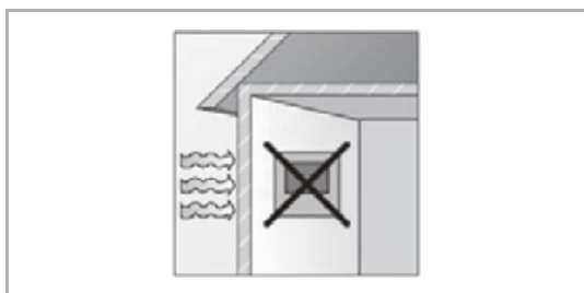
Fig. 5: Luogo di montaggio – parete esterna
