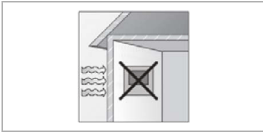
Fig. 5: Lugar de montaje - pared exterior
