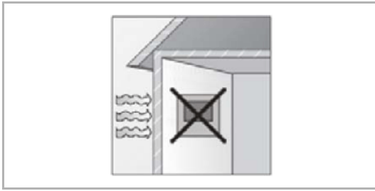
Fig. 5: Lugar de montaje - pared exterior
