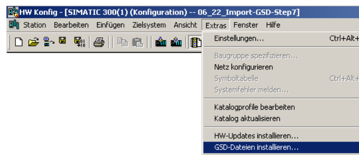
Abbildung 24: Installation der GSD-Datei starten in HW Konfig; Screenshot STEP7 mit freundlicher Genehmigung von SIEMENS, Nürnberg
