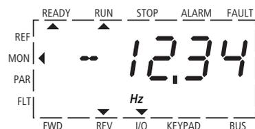
Abbildung 61: Betrieb (RUN) über Steuerklemmen (I/O) mit Linksdrehfeld (REV) (z. B. -12,34 Hz)
