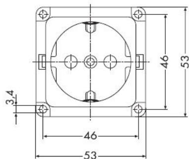
**Compacta Steckdose SCHUKO Einbau
