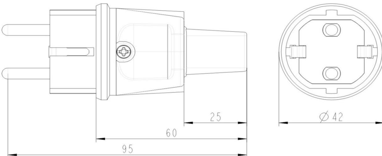
Abisolierung / Wire stripping: N 35 mm L 35 mm PE 35 mm
