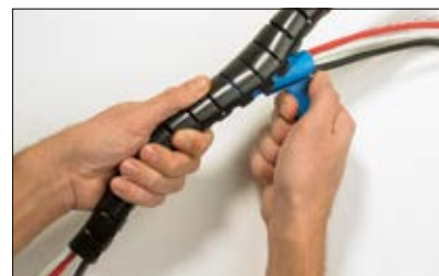
Trek de tool door de Helawrap-slang.
