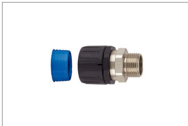
HGL-SM recht, draaibaar, buitendraad, met slangafdichting, IP68.
