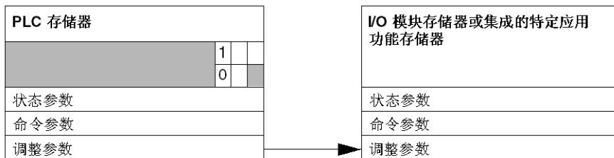
当通过 PLC 扫描到指令时，将 %MW<sub>r.m.c</sub> 中的正在交换位设置为 1。
