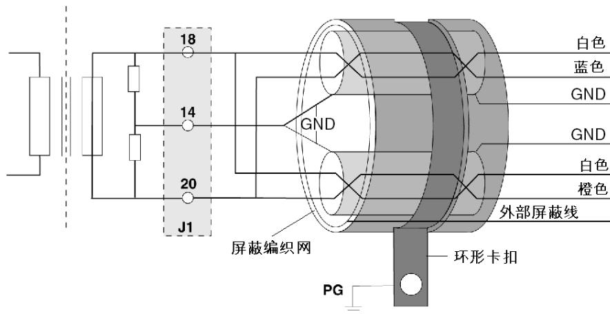
**注意：重要信息：**电缆的主屏蔽层使用与屏蔽编织网接触的金属卡扣进行接地，该编织网本身固定于支撑机架的框架上。
