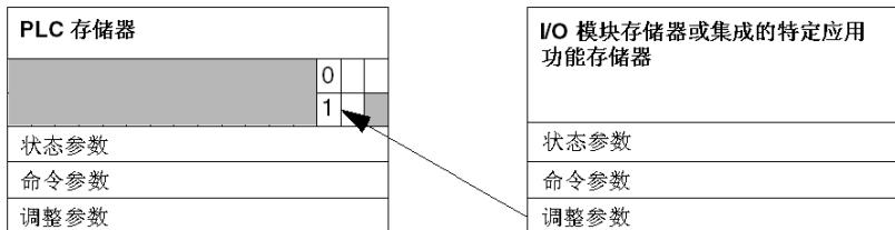
当在 PLC 存储器和模块之间交换数据时，由 ADJ\_ERR 位 (%MW<sub>r.m.c.1.2</sub>) 管理的模块进行确认。
