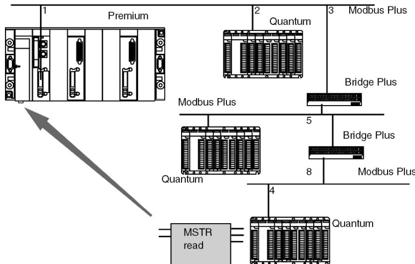
Quantum 工作站使用以下地址路径向 Premium 工作站发送一个读取请求：8.5.1.0.0 ( 路由路径 ) 。
