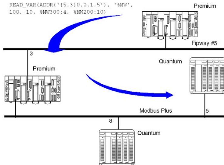
**注意：** Fipway 和 Modbus Plus 之间的路由是由系统自动执行的。在网络架构中，无需声明桥接工作站。
