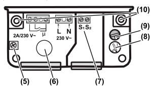
Bild 3: Anschlussraum Umsetzer
