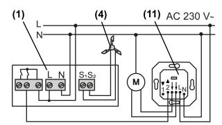
Bild 4: Anschlussplan Umsetzer an Jalousiesteuerung (11)
