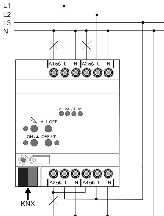
Bild 3: Geräteanschluss (Anschlussbeispiel)
