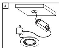
**Schritt 4 -** Verbinden Sie die Spots in Reihe über die Verteilerdose. Verbinden Sie die Schleifen mit den leeren Anschlüssen.
