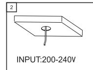
**Schritt 2 -** Vergewissern Sie sich, dass der Strom ausgeschaltet ist. Nehmen Sie die Phase und den Nullleiter an die L- und N-Seite des Treibers (oft braun und blau).
