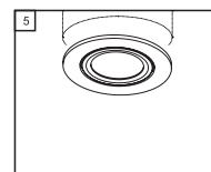
**Schritt 5 -** Wenn der Einbau Spot richtig platziert ist, klemmt er gegen die Decke/den Gebäuderahmen.
