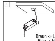
**Schritt 3 -** Schließen Sie die Phase und den Nullleiter an die L- und N-Seite des Treibers/Trafo angegeben.
