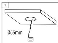
**Étape 1 -** Faites un trou dans le plafond d'un diamètre de 55 mm.
