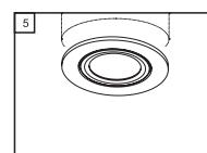
**Étape 5 -** Lorsque le spot encastré est placé correctement, celui-ci se clique au plafond/au cadre du système.
