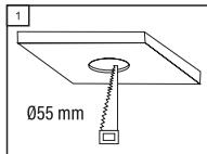
**Schritt 1 -** Ein Loch mit einem Durchmesser von 55 mm in die Decke machen.
