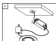
**Étape 4 -** Connectez les spots en série avec la boîte de distribution. Raccordez les boucles sur les connecteurs vides.
