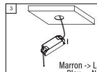
**Étape 3 -** Connectez les fils de phase et neutre au côté L et N du driver. (indiqué sur le conducteur/transfo).
