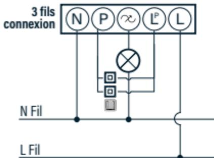
Possibilité de bouclage vers une prise / un interrupteur adjacent(e).
