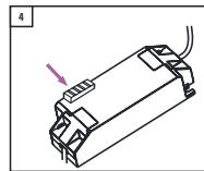
**Schritt 4 -** Wählen Sie die Lichtfarbe des Einbauspot mit dem Schieberegler.
