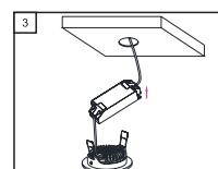
**Étape 3 -** Branchez le brin phase&neutre sur le côté L et N du pilote (indication sur le pilote «driver»/transformateur).
