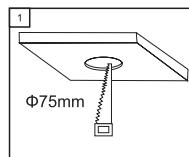
**Step 1 - Maak een gat in het plafond met een diameter van 75mm.**
