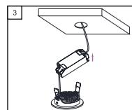
**Step 3 - Sluit de fase- en nuldraad aan, aan de L en N kant van driver.** (staat op de driver/trafo aangegeven).
