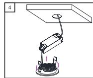
**Schritt 4 -** Die Einbauklemmen nach innen drücken und den Einbaustrahler in das Sägloch schieben.
