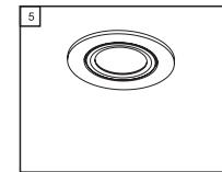
**Schritt 5 -** Wenn der Einbaustrahler richtig platziert ist, klemmt er sich selbst an der Decke fest.
