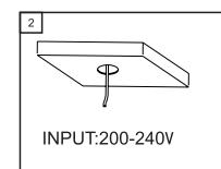
**Étape 2 -** Désjonnez le courant d'alimentation. Prenez brin phase&neutre sur le côté L et N du pilote (indication sur le pilote «driver»/transformateur).
