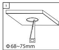
**Step 1 -** Maak een gat in het plafond met een diameter van 68~75mm.
