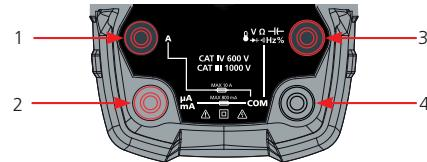
Alle Funktionen (außer Strom) verwenden die Eingangsanschlüsse VOHMS und COM. Zwei Stromeingangsanschlüsse.
