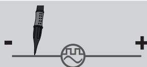
5. Setzen Sie die rote Prüfspitze an der Plusseite des Stromkreises an
