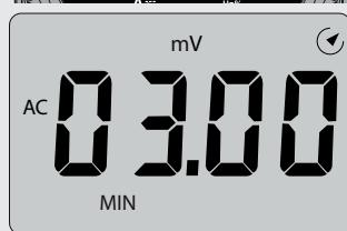
4. Drücken Sie die MAX/MIN-Taste erneut, um den MAX/MIN-Aufzeichnungsmodus zu aktivieren. „MAX-MIN“ wird angezeigt. Das Messgerät zeigt die Differenz zwischen dem MAX-Wert und dem MIN-Wert einige Zeit lang an
