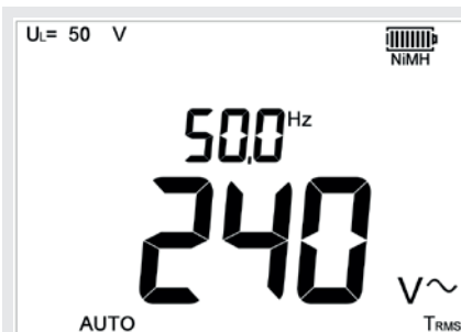
Bild 9: Displayanzeige MFT für Netzspannung und Frequenz.
