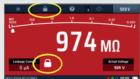
Abb. 23: Dauerhafte Fixierung der Isolationsprüfung
