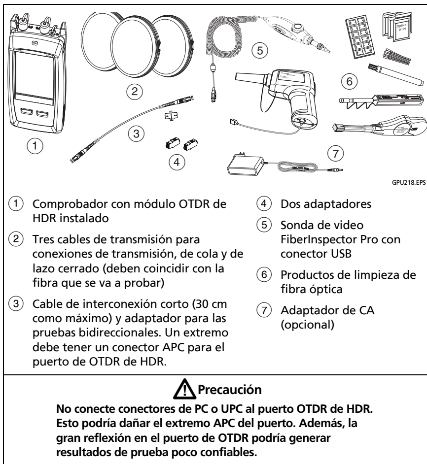
Figura 109. Equipo para las pruebas SmartLoop
