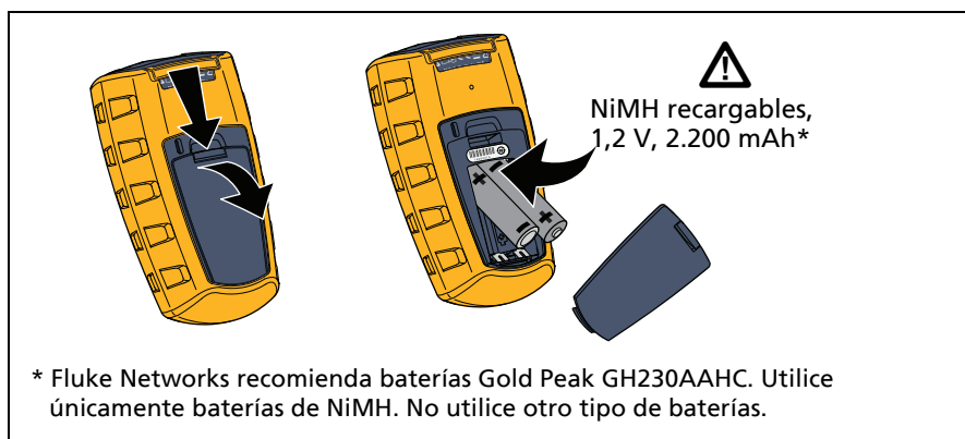
Figura 6. Reemplazo de las baterías
