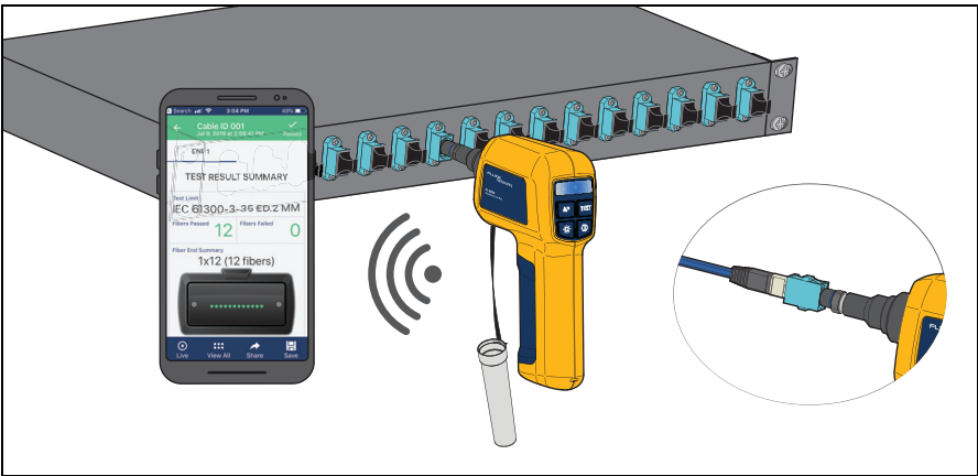
Abbildung 8. Untersuchung einer Endfläche (MPO abgebildet)
