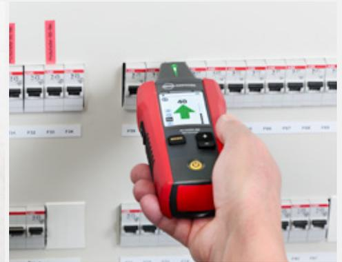
Zuordnung des richtigen Leitungsschutzschalters/Sicherung
