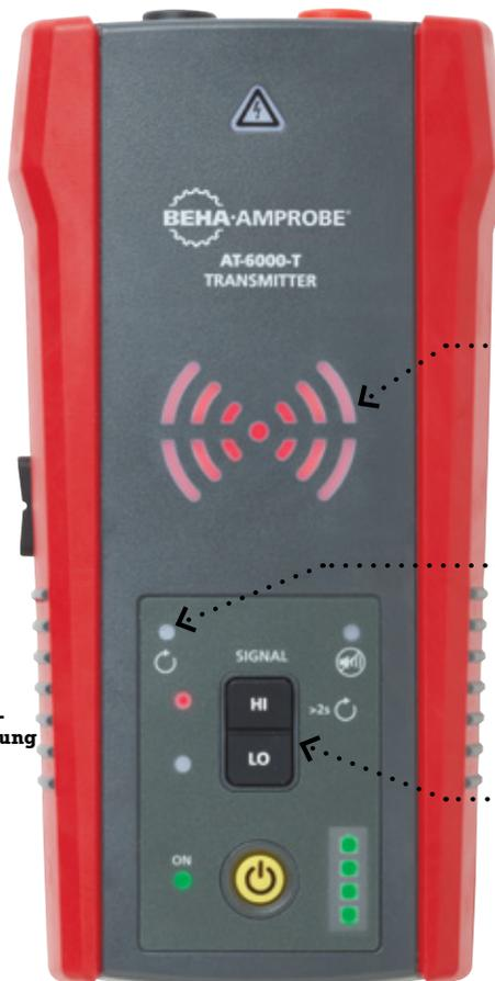
**Anzeige für Sendemodus** zeigt an, ob sich der Sender im Signalmodus Stark (HI), Schwach (LO) oder Schleife befindet
