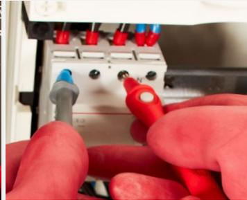
**Prüfspitze mit Testtaste**
