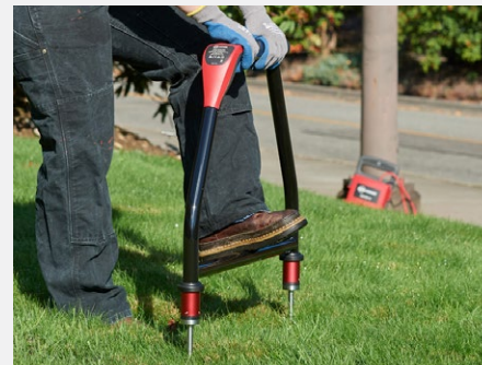
Individua la posizione di guasto utilizzando l'AF-600-EUR con il trasmettitore UAT-600-TE
