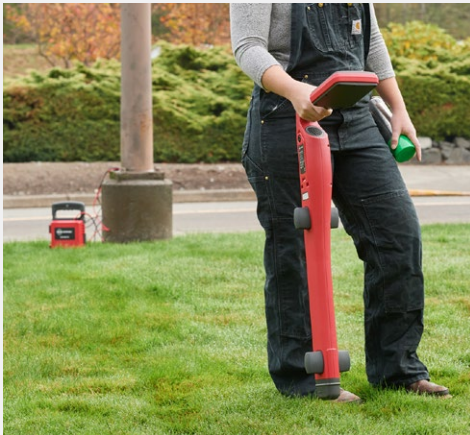
Traccia cavi o tubi singoli collegando il trasmettitore direttamente con i puntali
