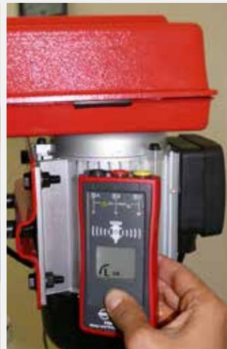
Rilevamento wireless della rotazione del motore
