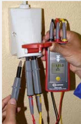
Convalida del cablaggio della presa
