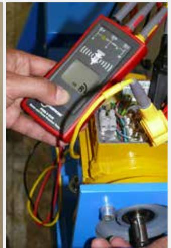
Controllo della rotazione del motore prima del collegamento
