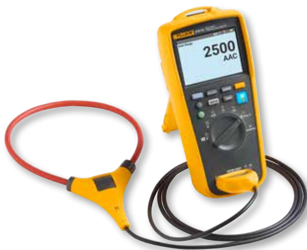
Figura 1. Fluke 279 FC con puntale di corrente flessibile iFlex
