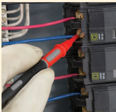
Exposición reducida de la punta para mediciones CAT III
