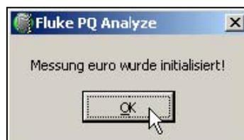
Klicken Sie auf "OK" und beachten Sie die "RECORDING STATUS"-LED am Gerät. Sie müsste anfangen, langsam zu blinken, um die Messaktivität zu signalisieren. g2\_9.bmp
