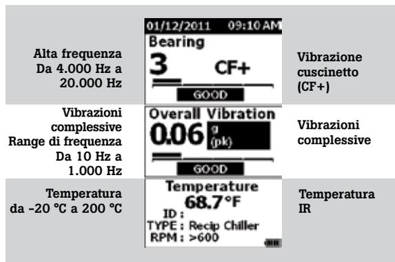
Schermata campione dei risultati di misurazione indicante una scala di gravità a quattro livelli (*Good [Buona], Satisfactory [Soddisfacente], Unsatisfactory [Insoddisfacente], Unacceptable [Inaccettabile]*) per il cuscinetto e la vibrazione complessiva
