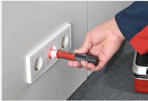
Überprüfung von Steckdosen auf Wechselspannung und Polarität
