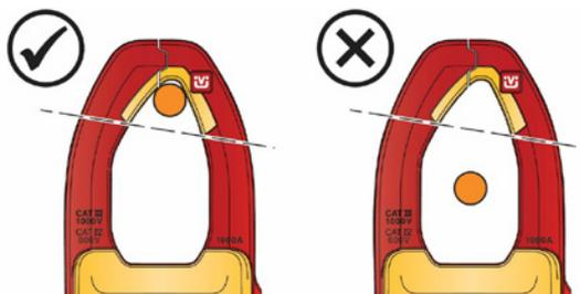
Die Leitung so nah wie möglich an der Zangenöffnung positionieren (siehe Abbildung).
