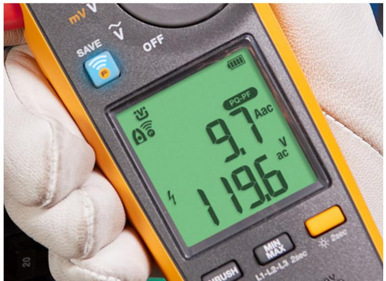
Die 378 FC enthält eine Netzqualitätsprüfung, die schnell Aufschluss darüber gibt, ob das Problem an der Stromversorgung oder im angeschlossenen Gerät liegt.
