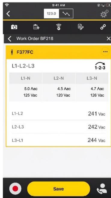
Fluke Connect fasst bei Dreiphasenmessungen alle Daten einschließlich der Phasendrehrichtung zusammen und stellt sie komplett dar, sodass Sie sich mit einem Blick eine Übersicht verschaffen können.
