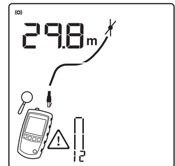
f) Vista de un par con distancia al cortocircuito
