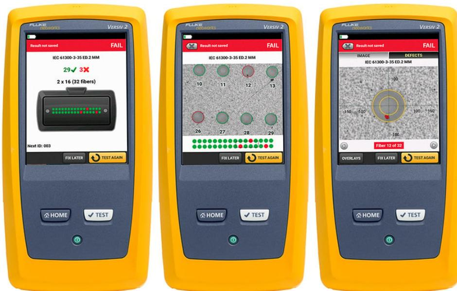
*Nahtlos von der Übersicht (links) auf ein Einzelbild (Mitte) umschalten, dann mit der gestenbasierten Bedienoberfläche eine Ansicht jeder einzelnen Glasfaser (rechts) vergrößern und über den gesamten Verbinder schwenken. Einzelne Glasfasern werden markiert, sodass man weiß, was man sich ansieht. Rote Defekte sind Fehler, grüne sind gemäß des ausgewählten Standards akzeptabel.*
