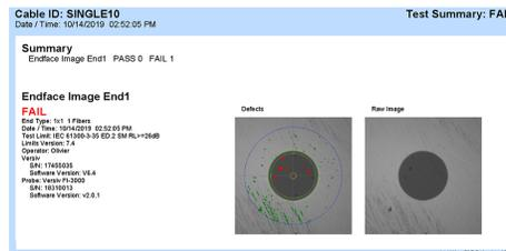
Detaillierte PDF-Messberichte vom Smartphone oder Versiv™-Messgerät erstellen. Versiv™ und LinkWare™ unterstützen auch integrierte Dokumentation, einschließlich Tier 1 (Dämpfung) und Tier 2 (OTDR) Messung.
