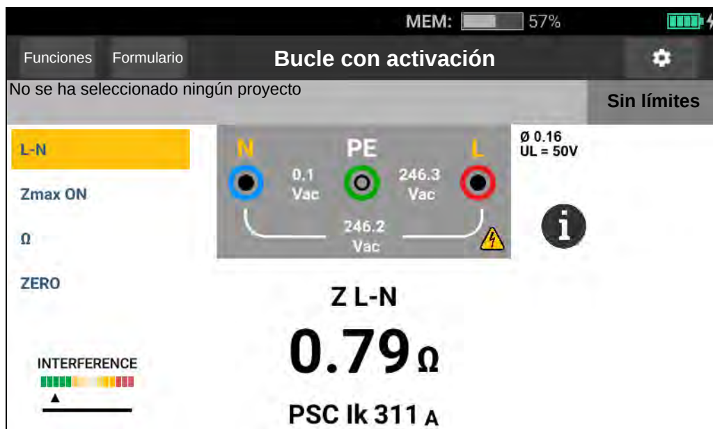
Figura 13. Pantalla de medición de impedancia de línea
