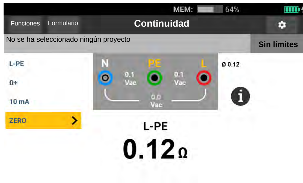
Figura 10. Pantalla de medición de continuidad
