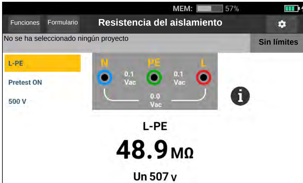
Figura 9. Pantalla de medición de la resistencia del aislamiento
