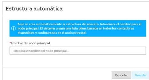
A continuación se representan automáticamente los participantes M-Bus detectados y configurados en una lista plana bajo el nodo principal.
