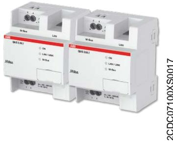
Los medidores de energía, M-Bus QA/S 3.xx.1 son aparatos para montaje en el raíl DIN (MDRC), en diseño Pro M para su montaje en el distribuidor, sobre un raíl de montaje DIN de 35 mm.
