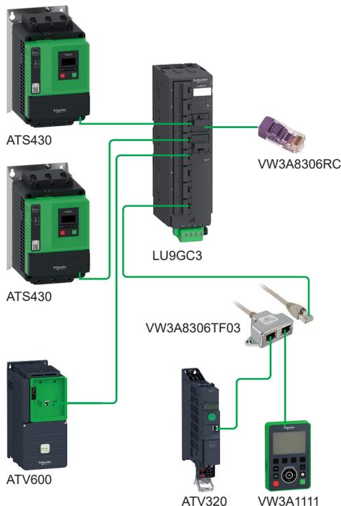
Exemple d'architecture multipoint avec un terminal graphique, un démarreur progressif ATS430 et d'autres appareils Altivar
