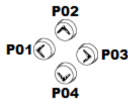
Abb. 113: Die Cursor-Tasten werden im Schaltplan als Kontakte P 01 bis P 04 verdrahtet.
