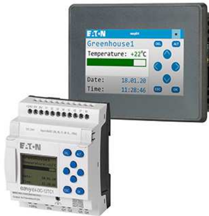
Rys. 393: Odzwierciedlanie wyświetlacza easyE4 na easyE RTD Standard
