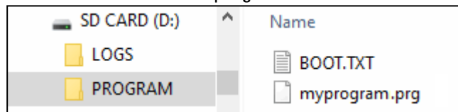
Fig. 71: L'unità scheda di memoria microSD con la cartella PROGRAMMA contiene il file BOOT.TXT e il programma compilato test.prg
