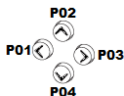
Fig. 113: Nello schema elettrico i tasti cursore sono cablati come contatti da P 01 a P 04.
