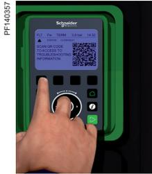
QR codes dynamiques intégrés générés lors de la détection d'erreurs
