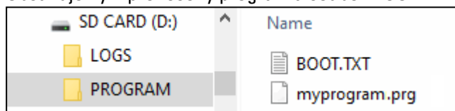
Obr. 71: Disková jednotka microSD paměťové karty s adresářem PROGRAM obsahuje BOOT.TXT a kompilovaný program test.prg
