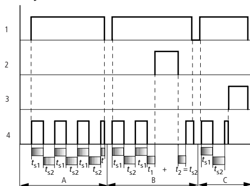
Obr. 152: Funkční diagram časového relé, podle impulsu
