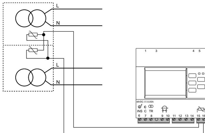
如果变压器有三柱，则将第三个温度传感器与另外两个传感器并联。
