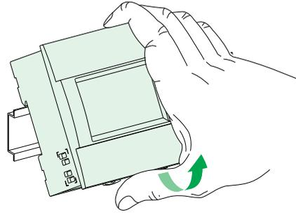
4. 重新插入端子板，确保观察到设备处于正确位置（请参阅硬件概述, 9 页）。
