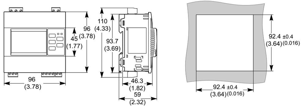
按照下图，注意设备之间的正确距离，以进行吸顶式安装：
