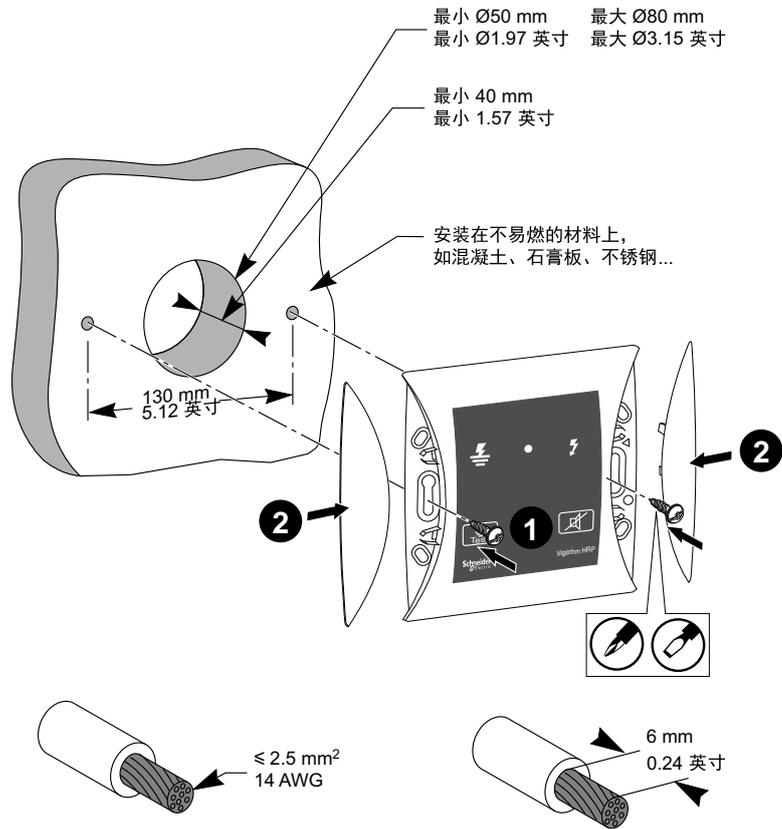
HRP 连接到绝缘报警继电器端子板。请参见从设备到 HRP 的接线图 ( 接线图, 18 页 )。HRP 连接器的详细信息如下图所示：
