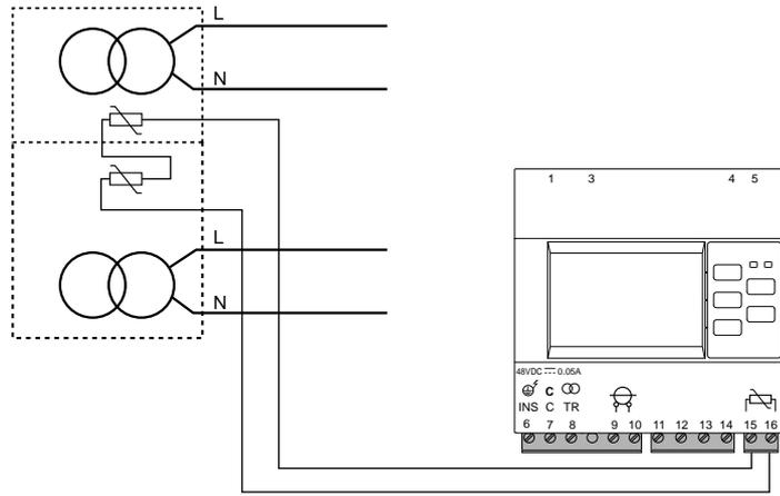
如果变压器有三柱，则将第三个温度传感器与另外两个传感器串联。
