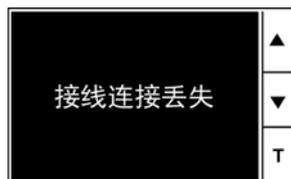
默认情况下，已激活检测断开的注入连接参数（参数断开注入连接设置为开）。
