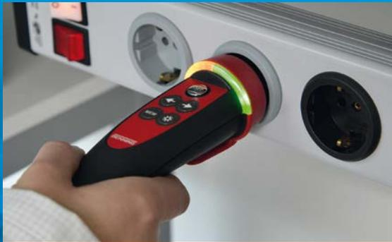
**Commander-Prüfstecker mit TEST-Taste**
