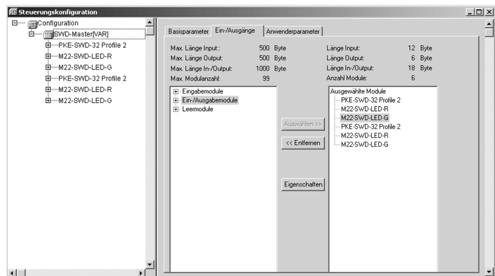
Die Schaltfläche **Eigenschaften** führt zum Dialog 'Moduleigenschaften' des aktuell selektierten SmartWire-DT Teilnehmers. Er zeigt den Namen, die Config (Kodierung des IO-Abbilds nach PROFIBUS-Norm) und die Ein- und Ausgabelänge des Moduls in Byte.
