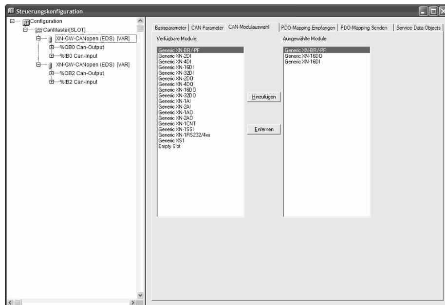
Ist das eingefügte CAN-Modul modular aufgebaut und unterstützt es die entsprechenden Standards (**DSP 301, V4.01 und DSP 306**), so erscheint die Registerkarte **CAN-Modulwahl**. Die Konfiguration des entsprechenden Aufbaus kann durch **Hinzufügen** oder **Entfernen** der Module vorgenommen werden.
