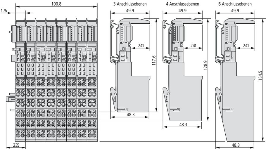
Abbildung 11: Basismodule in Blockausführung mit Schraubanschluss (XN-BxS...)
