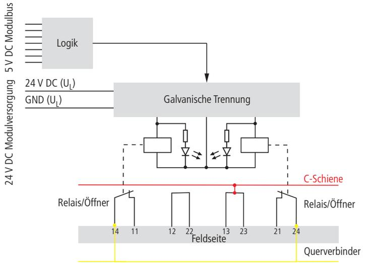
Abbildung 122: Blockschaltbild XN-2DO-R-NC mit dem Basis-
