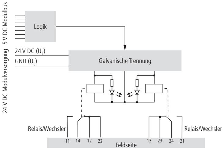
Abbildung 137: Blockschaltbild XN-2DO-R-CO mit dem Basis-
