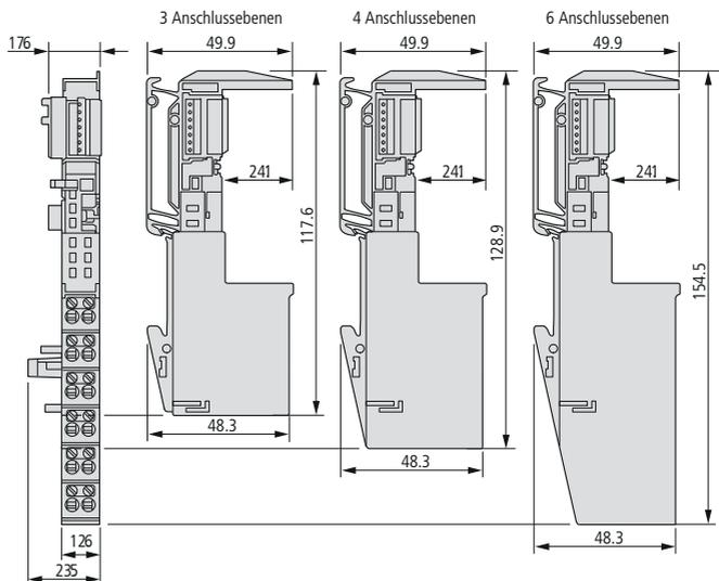
Abbildung 9: Basismodule in Scheibenausführung mit Schraubanschluss (XN-SxS..., XN-PxS...)
