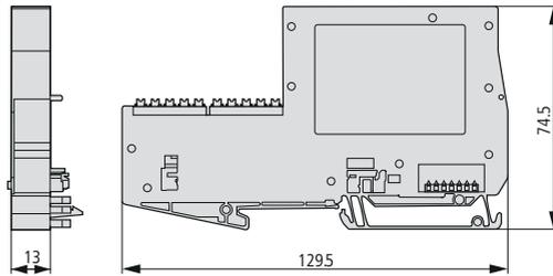
Abbildung 12: XNE ECO-Elektronikmodul:
