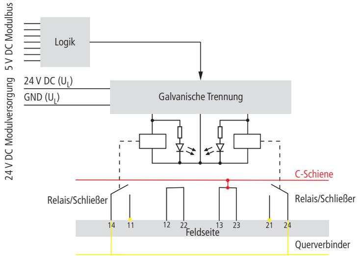
Abbildung 130: Blockschaltbild XN-2DO-R-NO mit dem Basis-
