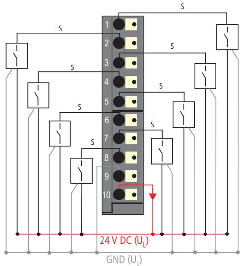
Abbildung 75: Anschlussbild XNE-8DI-24VDC-P mit
