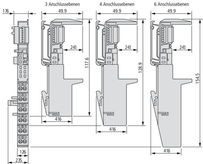
Abbildung 8: Basismodule in Scheibenausführung mit Zugfederanschluss (XN-SxT..., XN-PxT...)
