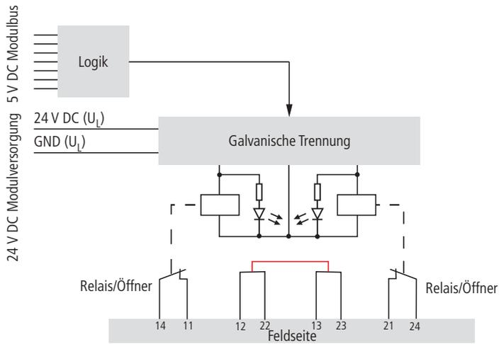
Abbildung 121: Blockschaltbild XN-2DO-R-NC mit dem Basis-
