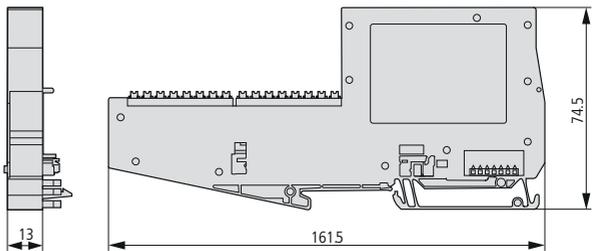
Abbildung 13: XNE ECO-Elektronikmodul:
