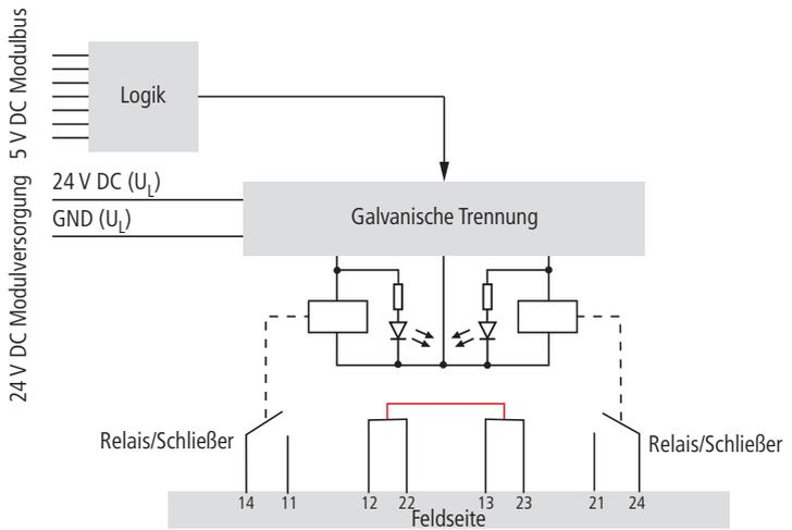
Abbildung 129: Blockschaltbild XN-2DO-R-NO mit dem Basis-
