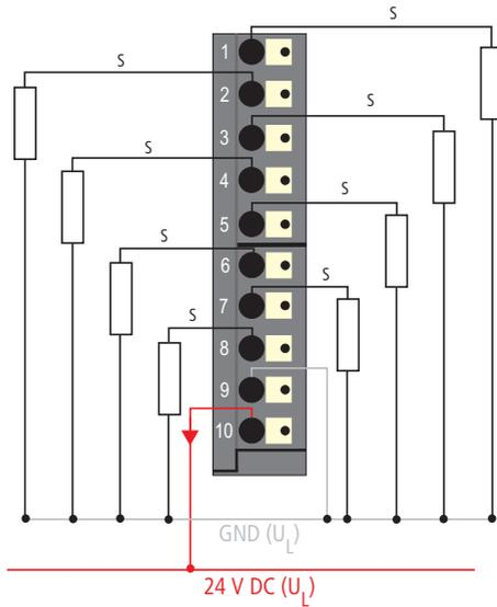
Abbildung 115: Anschlussbild XNE-8DO-24VDC-0.5A-P mit
