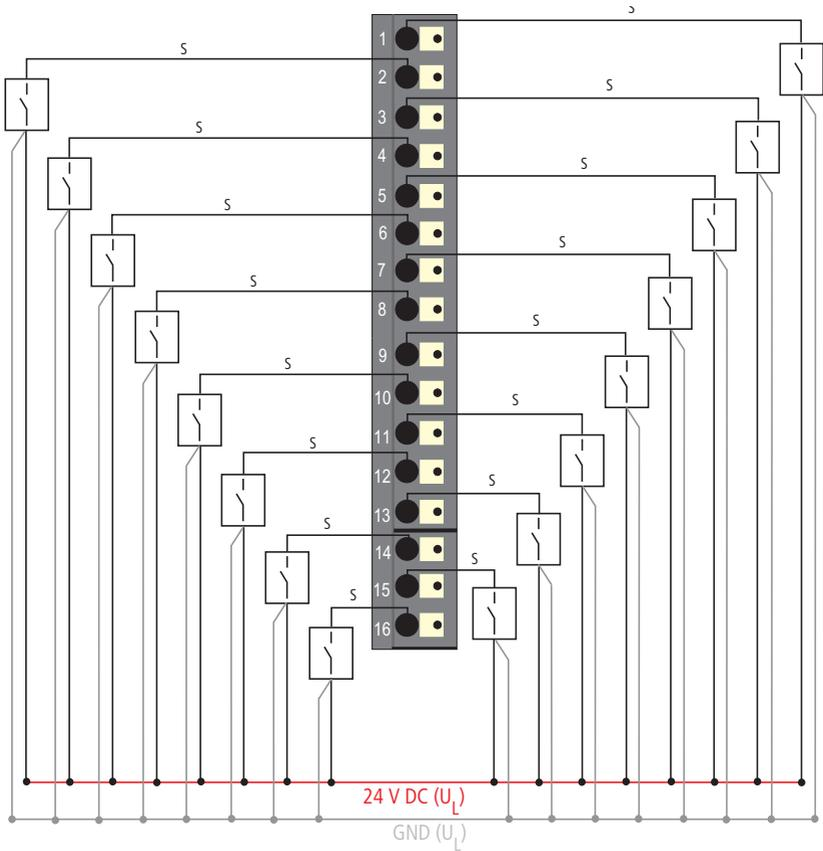
Abbildung 79: Anschlussbild XNE-16DI-24VDC-P mit
