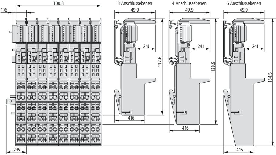
Abbildung 10: Basismodule in Blockausführung mit Zugfederanschluss (XN-BxT...)
