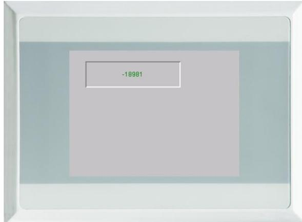
Darstellung der Startmaske aus dem Projekt *MyFirst*. Wenn das SPS Programm auf dem Gerät gestartet ist, muss sich der Wert fließend erhöhen.
