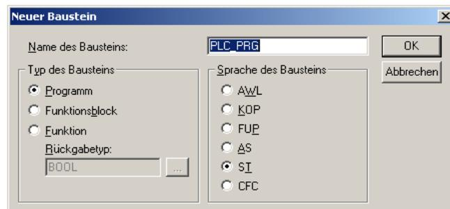
Danach ist unter dem Register „Bausteine“ das Programm „PLC\_PRG“ zu öffnen und eine einfache Zuweisung im Anweisungsteil des Programms zu erstellen:
