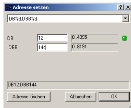
Das abgebildete Beispiel zeigt die Adressierung einer Variablen für eine S7 Steuerung über MPI. Die Nomenklatur einer Variablen ist aus den Datenbausteinen der Steuerung gewählt. Die Adressierung ist hierbei auf DB12 Byte 144 gewählt.
