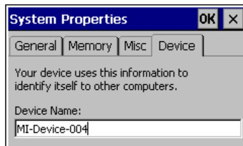
Im Register «Device» wird der Netzwerkname angezeigt. Der Netzwerkname kann auch mittels [Netsetup](#) gesetzt werden. Nach Veränderung des Netzwerknamens kann das Gerät optional neu gestartet werden.
