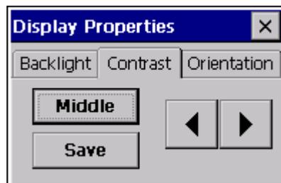
Dieses Programm dient zur Einstellung des Bildschirmkontrastes. Mit «Middle» wird der werkseitig abgespeicherte Mittelwert eingestellt. Mittels «Save» wird die gewählte Einstellung persistent abgespeichert, d. h. sie bleibt auch nach einem Neustart erhalten.
