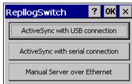
Das Programm «Repllogswitch.exe» dient zur Verbindungsaufnahme mittels ActiveSync oder «Manual Server» zu einem PC. Das Vorgehen ist den Kapitel [Vorgehen: ActiveSync](#) resp. [Vorgehen: Manual Server](#) zu entnehmen.
