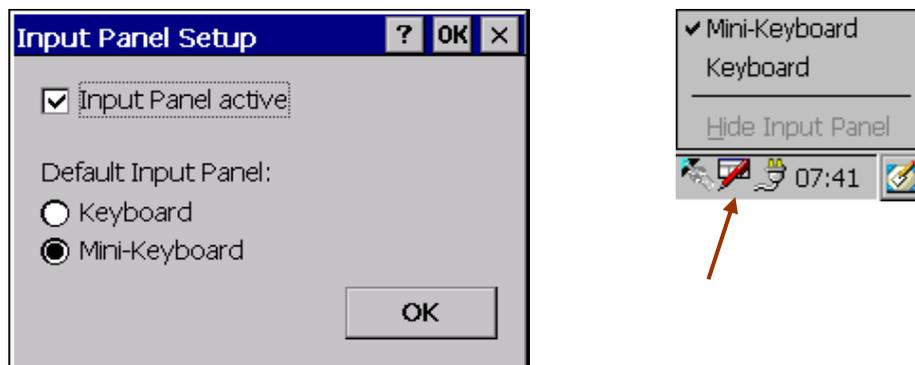
Um die Zeicheneingabe am Gerät zu ermöglichen, stehen verschiedene Software-Tastaturen zur Verfügung. Mit der Einstellung «**Input Panel active**» kann die Software-Tastatur aktiviert bzw. deaktiviert werden. Standardmässig ist die Option deaktiviert. Eine Veränderung dieser Einstellung bedingt einen Neustart des Systems.
