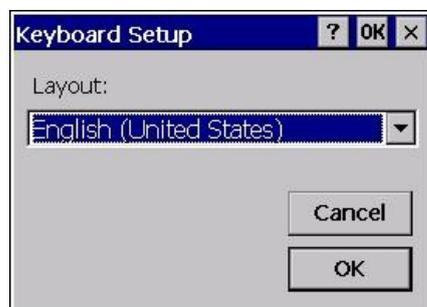
Das Keyboard Setup – Kontrollpanel nimmt die Ländereinstellung für eine USB-Tastatur vor. Innerhalb des oben abgebildeten Dialoges können Sie das gewünschte Tastatur-Layout auswählen. Das eingestellte Tastatur-Layout bleibt auch nach einem Neustart erhalten.
