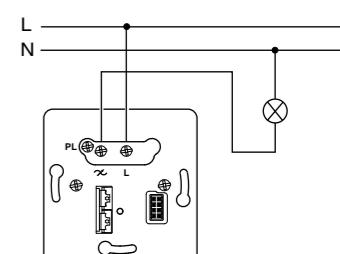
**Einsatz mit mechanischem Taster über PlusLink**
